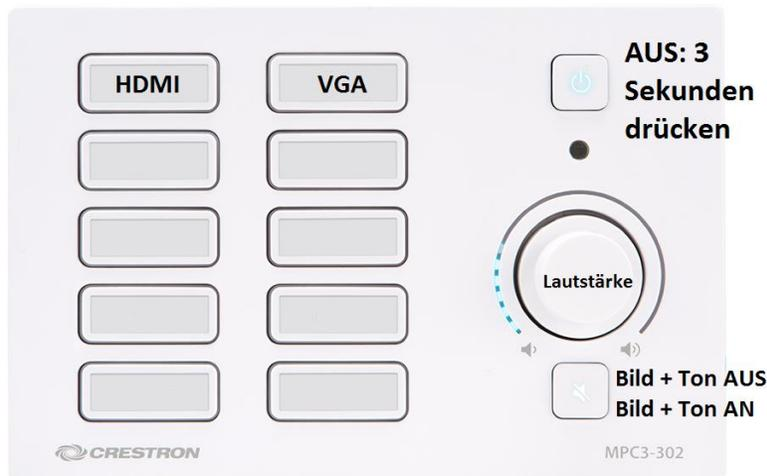
Beim Wechsel des Laptopanschlusses können Sie das Bild über das Bedienfeld an der Wand steuern: **HDMI** oder **VGA**
